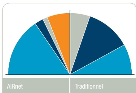
Dans une installation compresseur, une perte de charge de 1 bar entraîne une consommation supplémentaire d'énergie de 7 %. AIRnet offre des pertes de charge minimales qui se traduisent par des économies. Les raccords et tuyaux étanches et anticorrosion réduisent les interruptions et assurent une haute efficacité.
